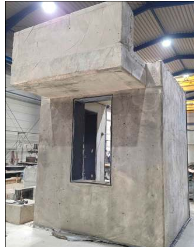
Entschaltes Versuchsteil mit Schaummörtel-Hülle
